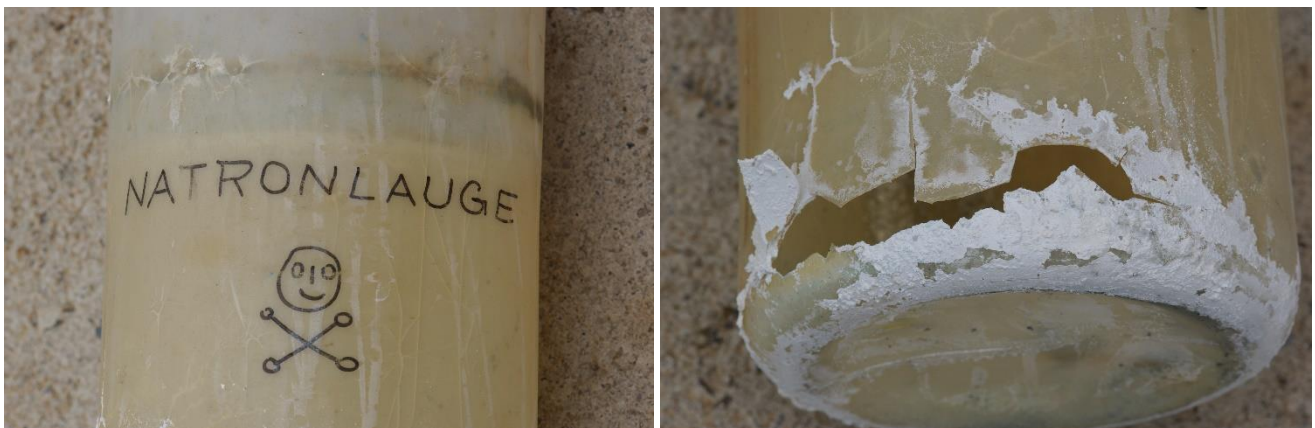
Polyethylen- Kanister (ca. 5 l) mit Natronlauge (zum Abbeizen) über 15 Jahre befüllt; dessen Boden durch das Eigengewicht des Inhalts (1/2 voll) beim Anheben weggebrochen war.
