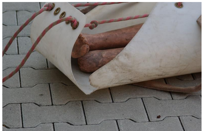
Einriss der Biegefalte an einer Trage aus Kunststoff (13 Jahre alt) durch mechanische Beanspruchung — kein Alterungsschaden.
