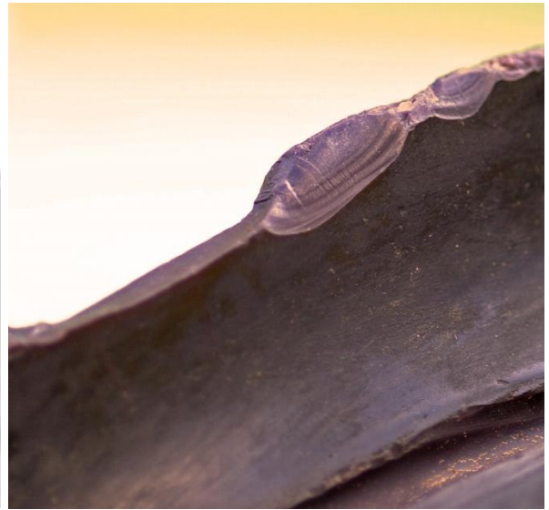
Ausgebrochene Borde an der Spillscheibe aus Vulkollan® einer Rettungswinde.
