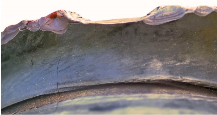
Ausgebrochene Borde an der Spillscheibe aus Vulkollan® einer Rettungswinde.
