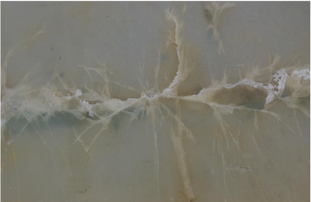
Risse und Brüche beim selben Kanister, verursacht durch leichten Fingerdruck
