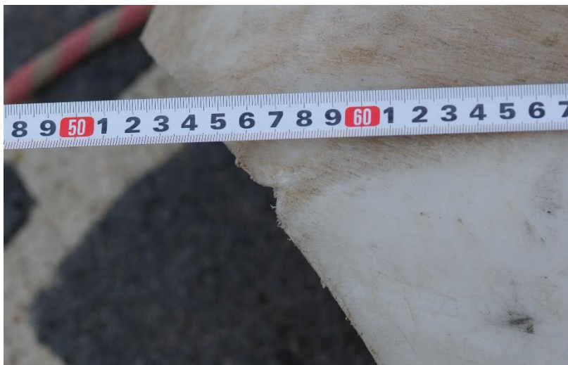
Schrammen durch mechanische Beschädigungen an einer Trage aus Kunststoff (13 Jahre alt) — kein Alterungsschaden.
