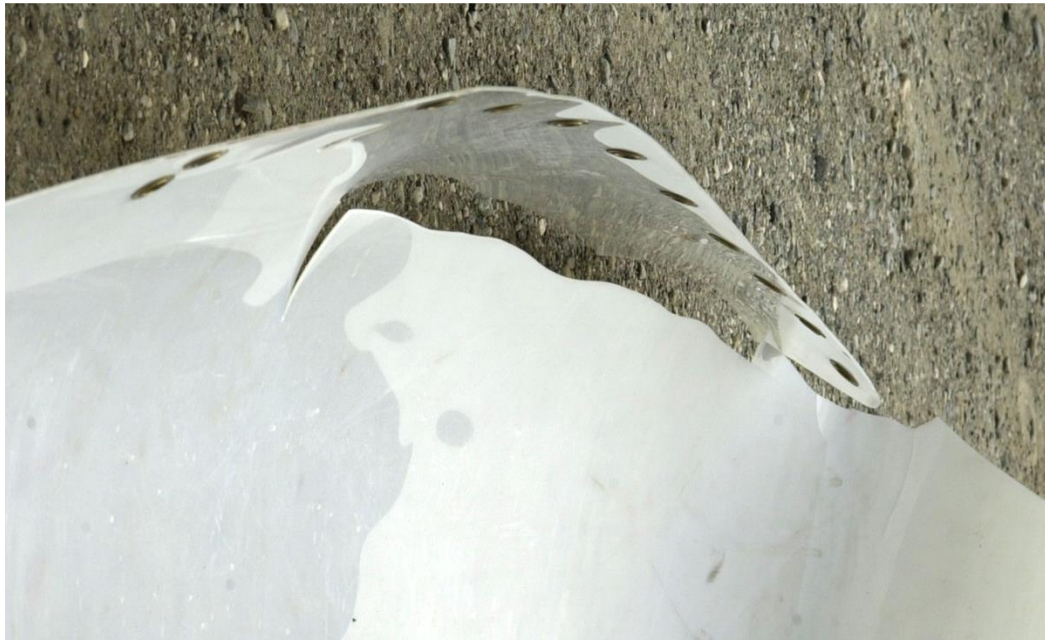
Alterungs– Sprödbbruch an einer Rettungstrage.
