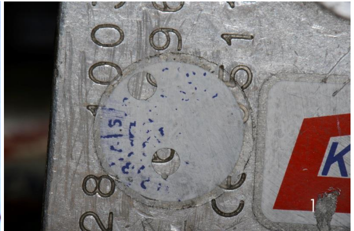
Durch eine zwischenzeitlich bereits abgenutzte Prüfplakette überklebte Artikel- Kennzeichnung und Fabrikationsnummer
