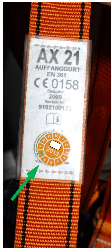
2-fach mit Prüfplaketten überklebte Herstellerangabe — eine Verwendung des Auffanggurtes ist nicht mehr zulässig, wenn die Herstellerangaben nicht mehr lesbar sind (grüner Pfeil)!
