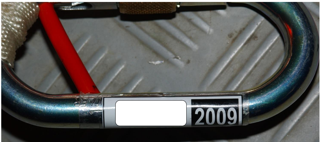
Überklebung der gesamten normgerechten Herstellerkennzeichnung durch eine Prüfplakette — da die Kennzeichnung dadurch nicht mehr lesbar ist, darf das Produkt somit nicht mehr verwendet werden!
