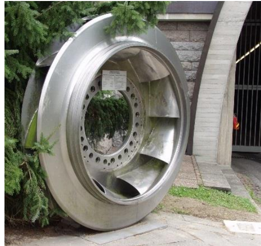
Laufrad eine Francisturbine mit \varnothing 2,73 m; 2,8 t.
