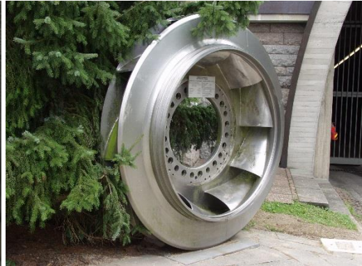
Laufrad eine Francisturbine mit \varnothing 2,73 m; 2,8 t.
