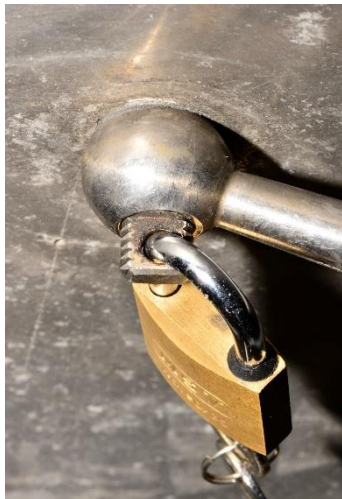
Bügelverschluss am Knebelgriff an einem Behälter — handelsübliches Vorhängeschloss im abgeflachten Gewindeende.
