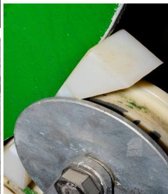
Kunststoffkeile zur Absicherung der Drehbewegung eines Behälters.
