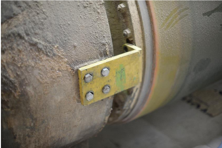
Professionelle Verdrehsicherung an einer Walze einer Papiermaschine.
