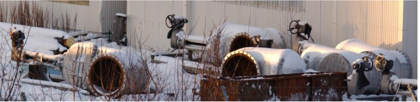
Großschieber Ø 2,0 m für Geothermalversorgung in Island — Freilager im Hafen.
