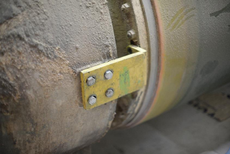
Professionelle Verdrehsicherung an einer Walze einer Papiermaschine.
