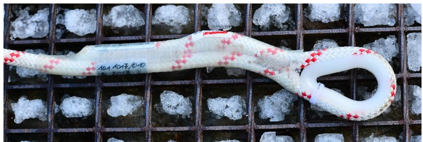
Vernähtes Testseil mit Belastungsindikator.
