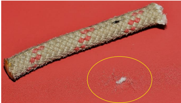
Von außen als unbedenklich erscheinendes Kernmantelseil — darunter rechts durch bloßes Bewegen mit den Fingern "herausgefallene" Faserbruchstücke.
