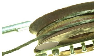
Bremsscheibe nach 80 m Abseilstrecke mit einer Person.
