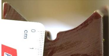
Das Stahlseil hat bereits nach 40 Abseilm Metern mit einer Person diese Rille mit einer Tiefe von 5 mm "herausgearbeitet".
