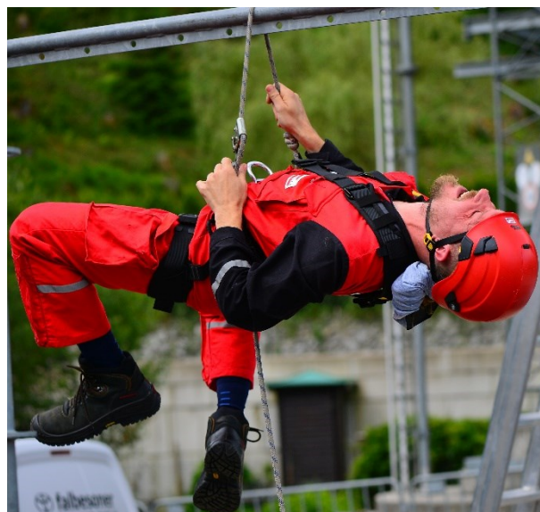
Bereits bloßes Hängen im Auffanggurt mit "Rückenstütze für Haltefunktion" ist lebensbedrohlich.
