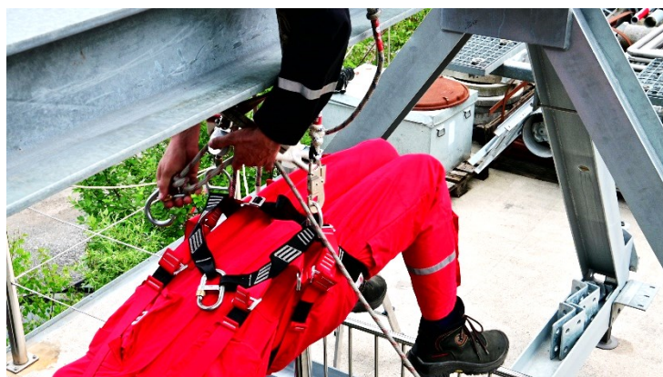
Hängeposition in den Ösen für Haltefunktion ohne Belastung der Wirbelsäule.
