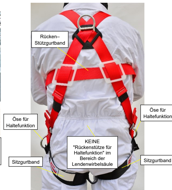
Auffanggurt mit beidseitigen Ösen für Haltefunktion, jedoch ohne "Rückenstütze für Haltefunktion".
